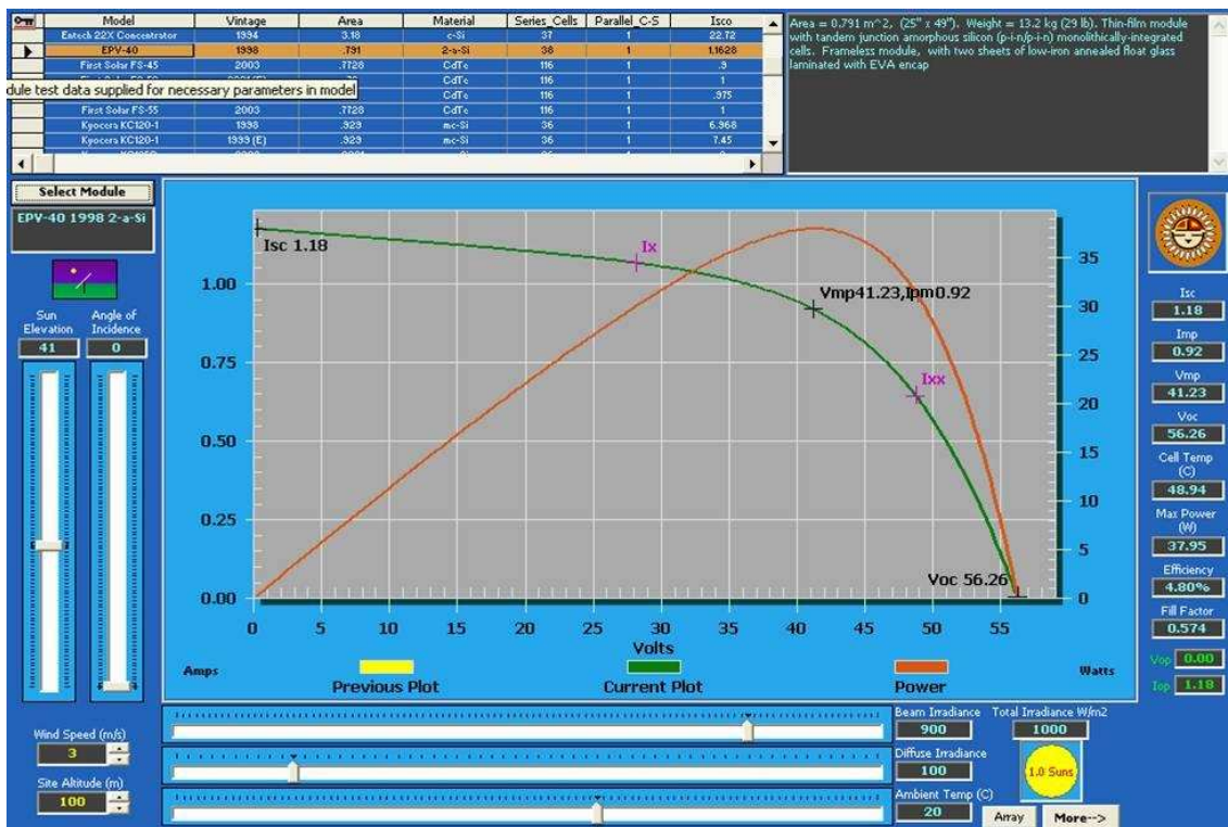
รูปที่ 1 กำลังผลิตสูงสุดของแผงเซลล์แสงอาทิตย์ ที่ความเข้มแสง 1,000 วัตต์/ตารางเมตร แสดงโดยใช้ I-V curve
