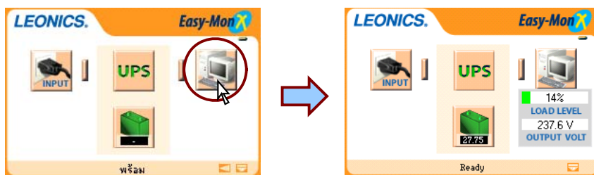
รูปที่ 9 แสดงแรงดันไฟฟ้าด้านออกและปริมาณการใช้งานอุปกรณ์ไฟฟ้า (AC output volt and load level)
